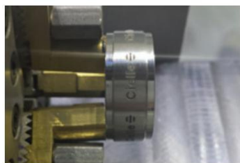
Divisore 4° asse por incisona Eixo de indexação rotativo para gravar
